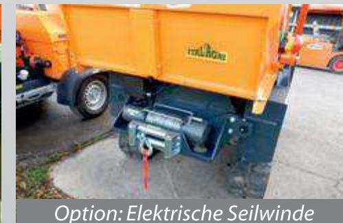
Option: Elektrische Seilwinde
