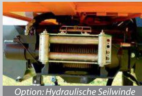
Option: Hydraulische Seilwinde
