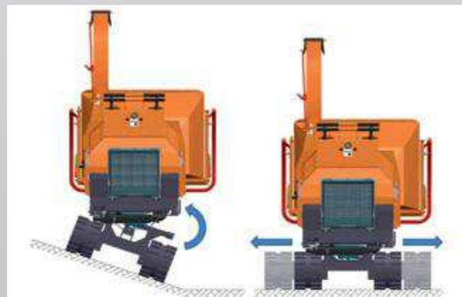
Egal ob Sie an Gleisanlagen, Autobahnböschungen oder auf schwierigem und steilem Gelände Arbeiten durchführen müssen, Sie kommen mit den Raupenhackern überall hin und können an Ort und Stelle Busch- und Stammholz zerkleinern.
