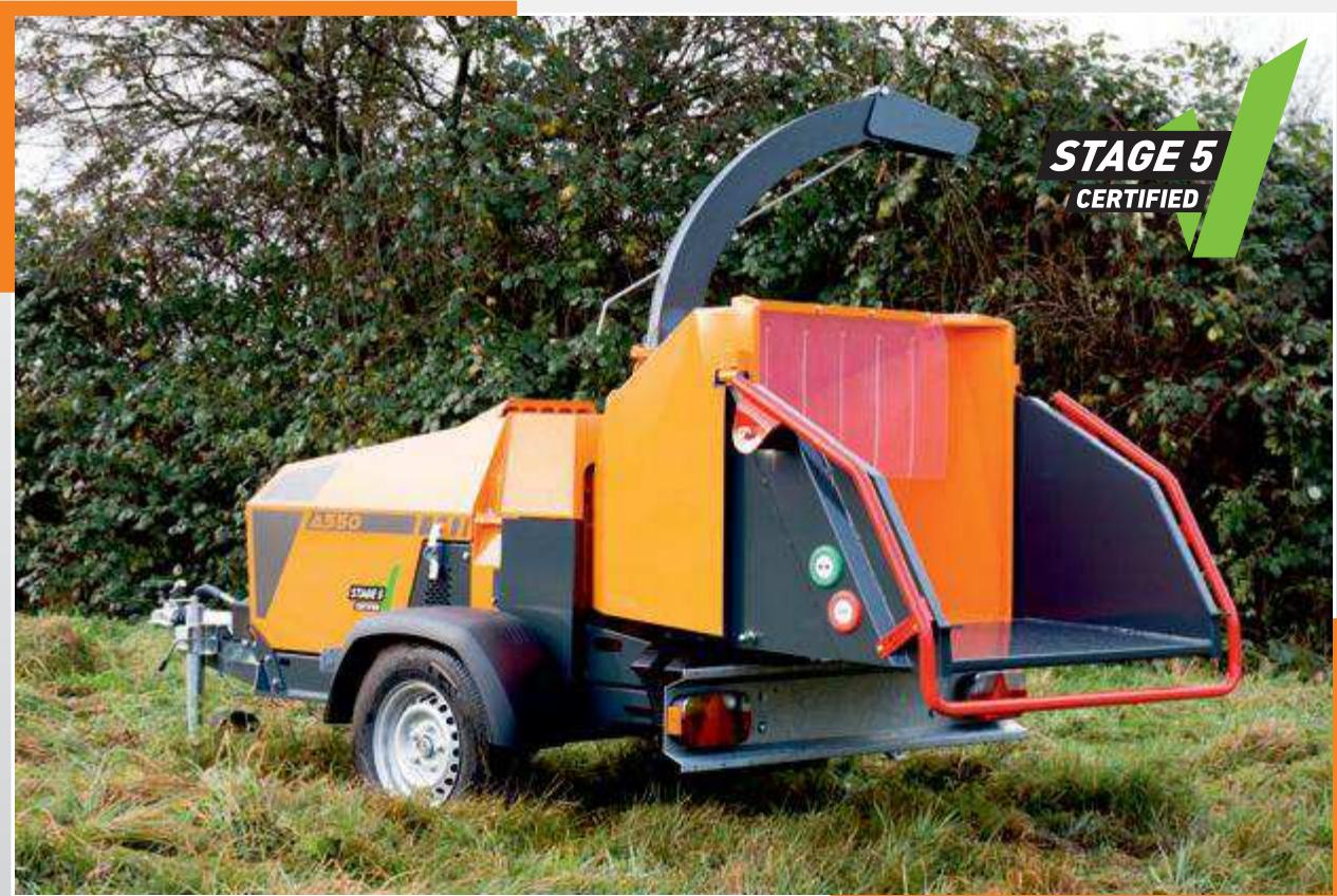
Durch den Einsatz eines Partikelfilters bleibt der A550 mit seinem 27,2 kW YANMAR Dieselmotor umweltfreundlich.
